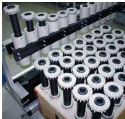
*Serielle Montage und Prüfung von Alu-Zylindern*
