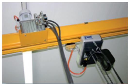
Mittels Hydraulik-Schrauber Marke „Eigenentwicklung“ und mechanischem Anzugsmomentverstärker werden die Endflansche mit dem Zylinderrohr verschraubt. Die nötige Kraft kommt vom Hydraulikaggregat oben auf der Kranbahn, welches einen Hydromotor mit hohem Drehmoment treibt.
